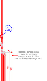
07 DETALHE VENTILAÇÃO ESCALA 1/25
